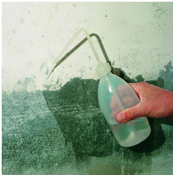
De muur kan voldoende goed geolied worden. Zoals hier getoond wordt, dringt het water een beetje in en rolt het er niet direct af.
